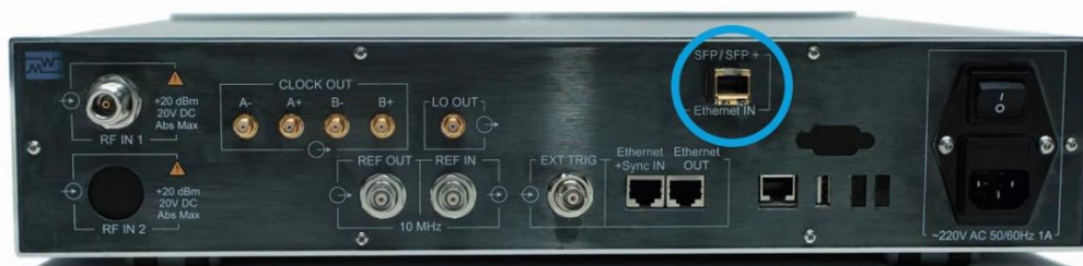
Рис. 5. Разъем SFP/SFP+ для управления прибором по Ethernet
