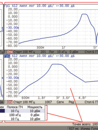
Развертка с разбиением частотного диапазона на сегменты
